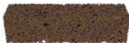
AMOSTRA GERADA ARTIFICIALMENTE da microestrutura de uma rocha Bentheimer, de tamanho 12x3x3 mm
