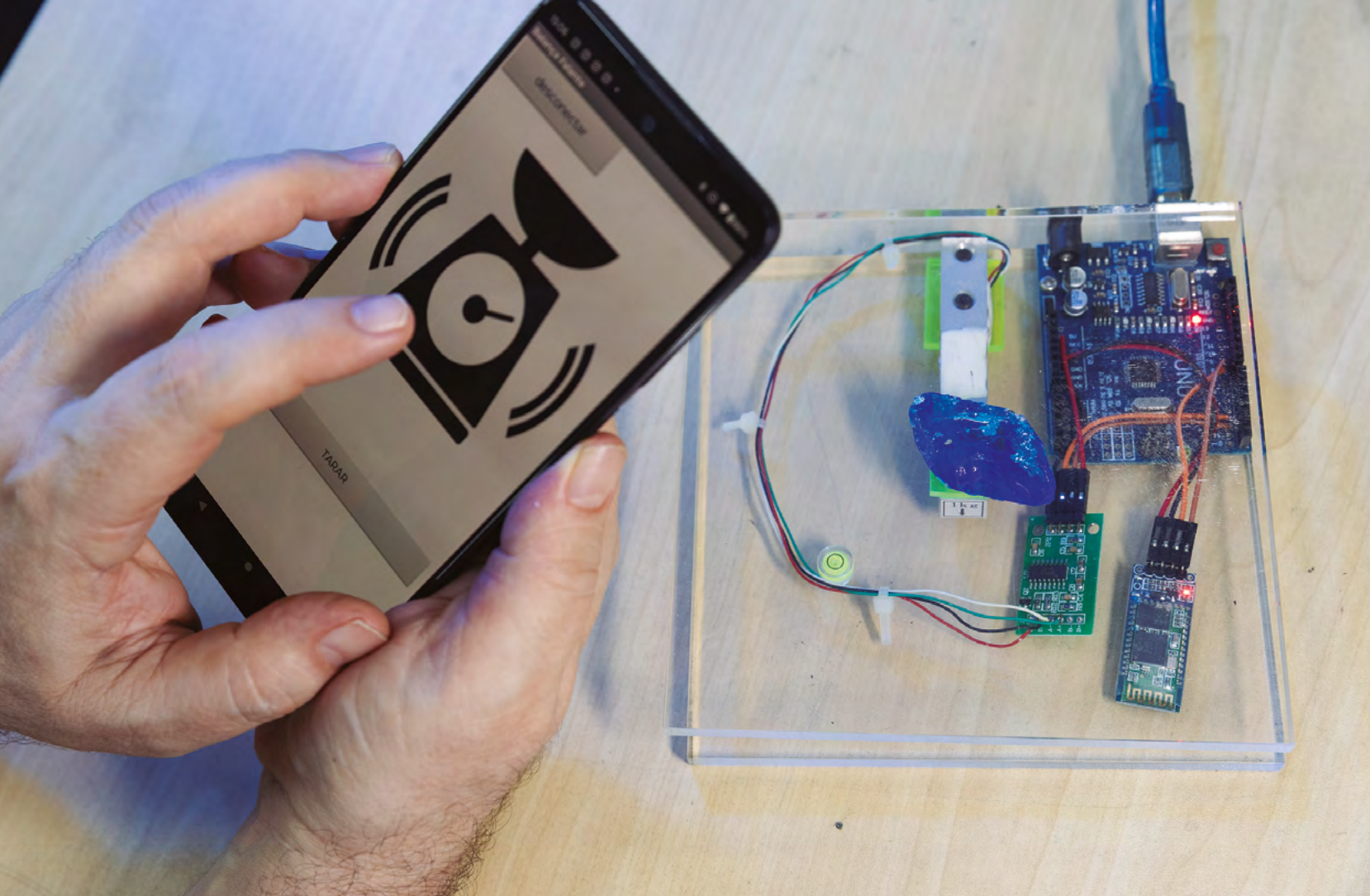
A “ BALANÇA FALANTE ” comunica o resultado da medição por áudio. Um celular previamente configurado informa a massa do objeto
